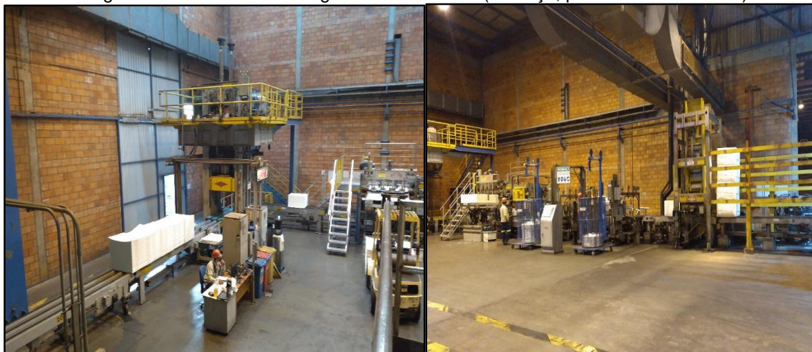
Imagem 20 – Setor de embalagem e acabamento (Balança, prensa e amarradeira)
