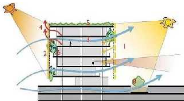
Figura 03 – Representação do funcionamento do Brise
