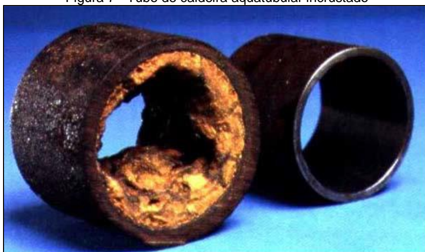
Figura 7 - Tubo de caldeira aquatubular incrustado
