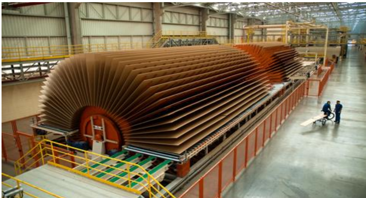
Foto 3: Roda de resfriamento e climatização
